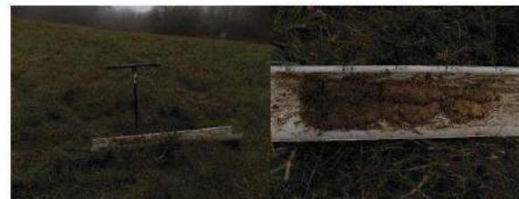
Sur le carottage du point de prélèvement 48, des traces d'oxydation sont observées à 25 cm.
